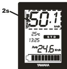
Dynamik-Modus ein: 50,1 km/h wird für 2 Sekunden angezeigt.
