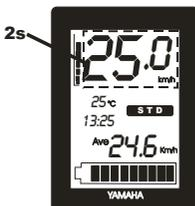
Das Display zeigt für 2 Sekunden 25,0km/h. Der Speed Modus ist aus.
